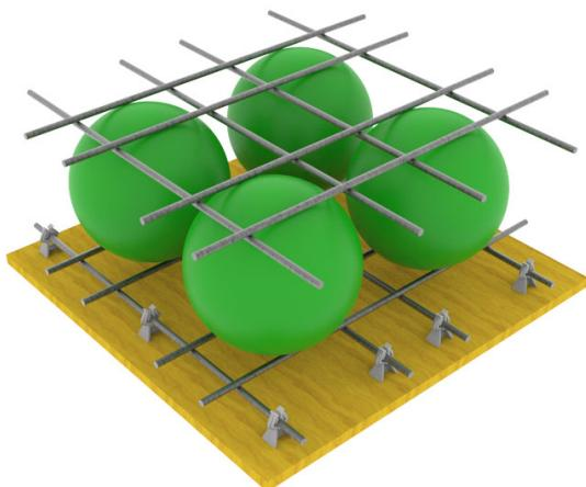
Cuando la malla de acero es hormigonada se obtiene una verdadera losa hueca “monolítica”..
